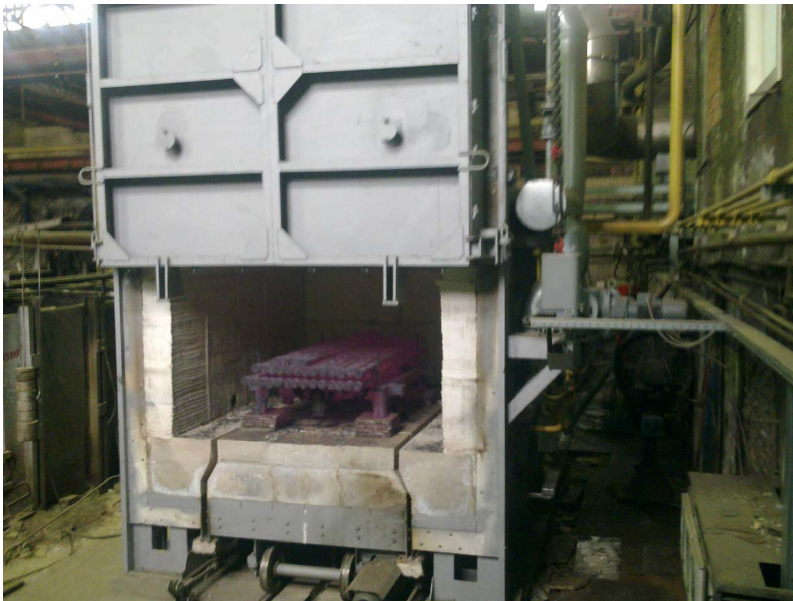
Рис. 5. Печь с выкатным подом для термообработки торсионов и др. изделий. ОАО «МЕТРОВАГОН-МАШ»
