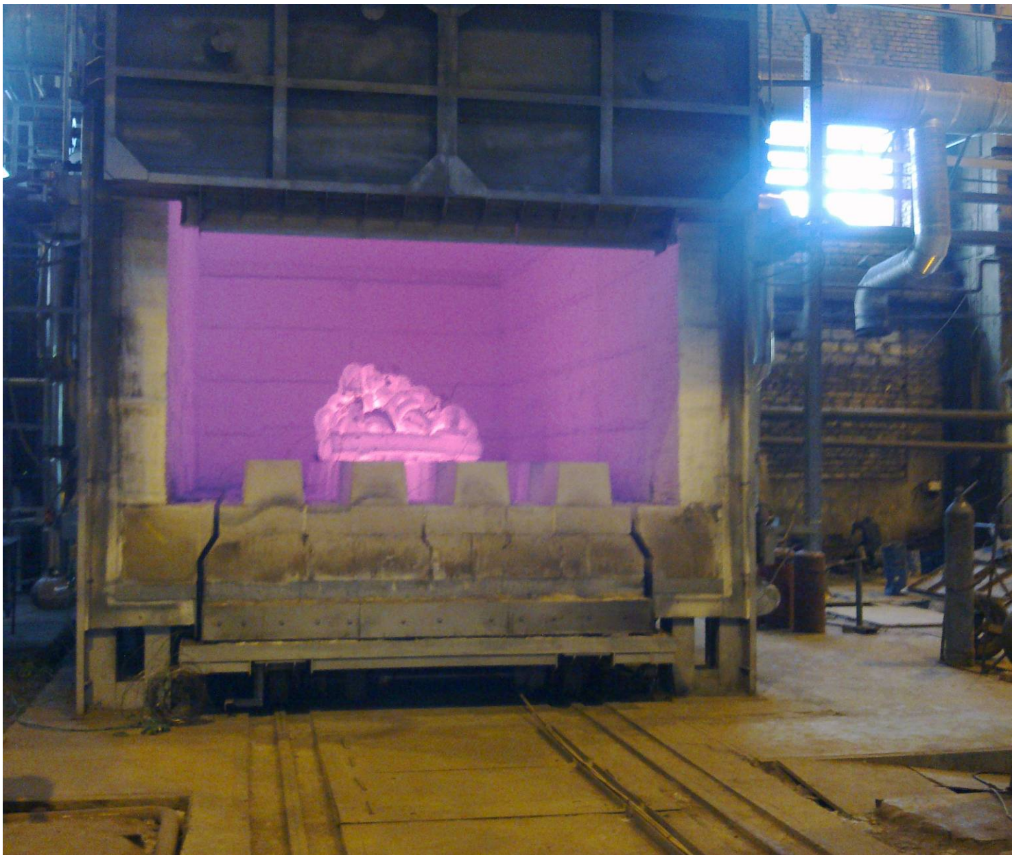
Фото 9. Печь с выкатным подом с размером рабочего пространства 6000x3500x2500 мм.
