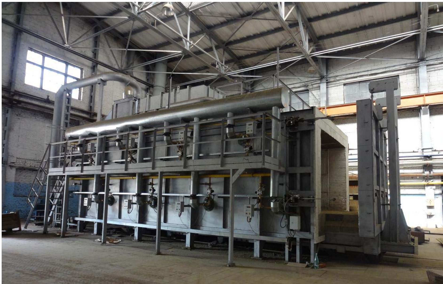
Рис. 4. Печь с выкатным подом для термообработки сварных рам вагонов метро. ОАО «МЕТРОВАГОН-МАШ»
