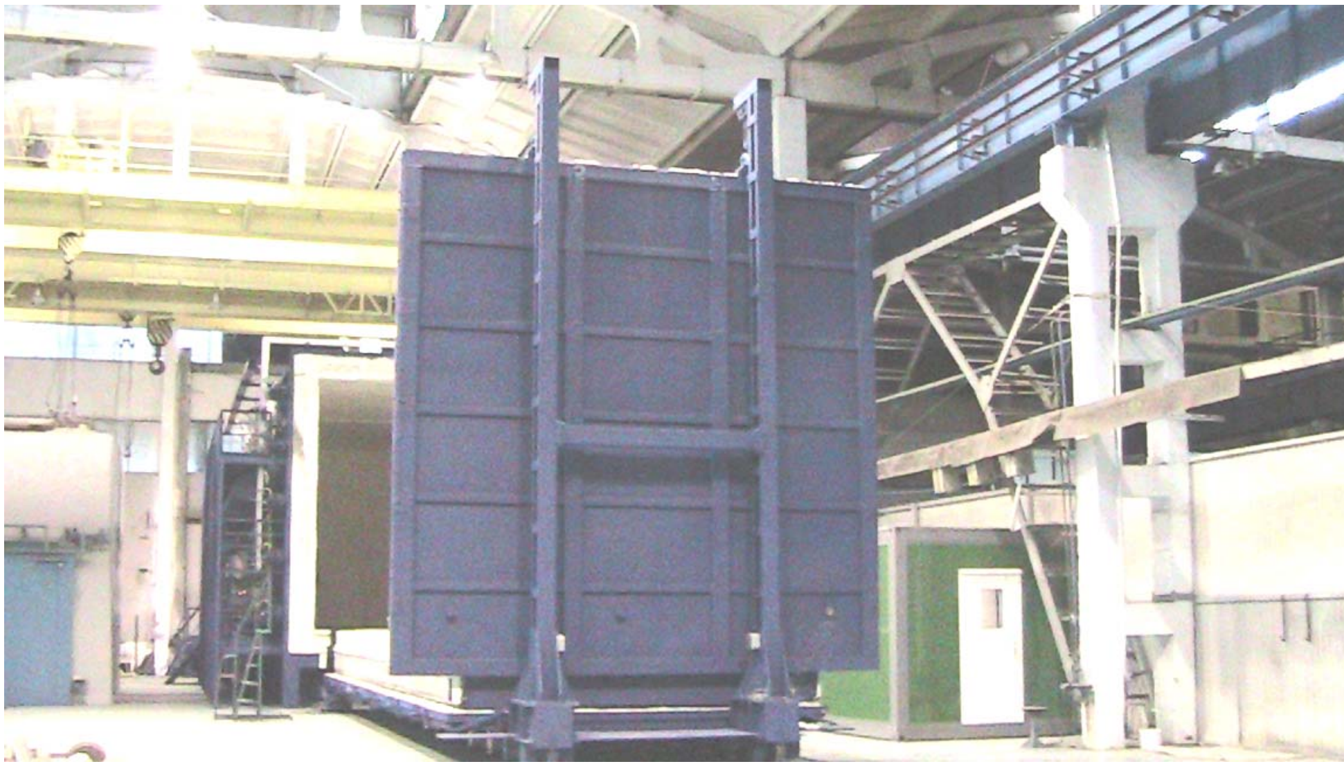
Фото 1. Газовая печь с выкатным подом, построенная ООО «АНХ-Инжиниринг» в 2009 г.
