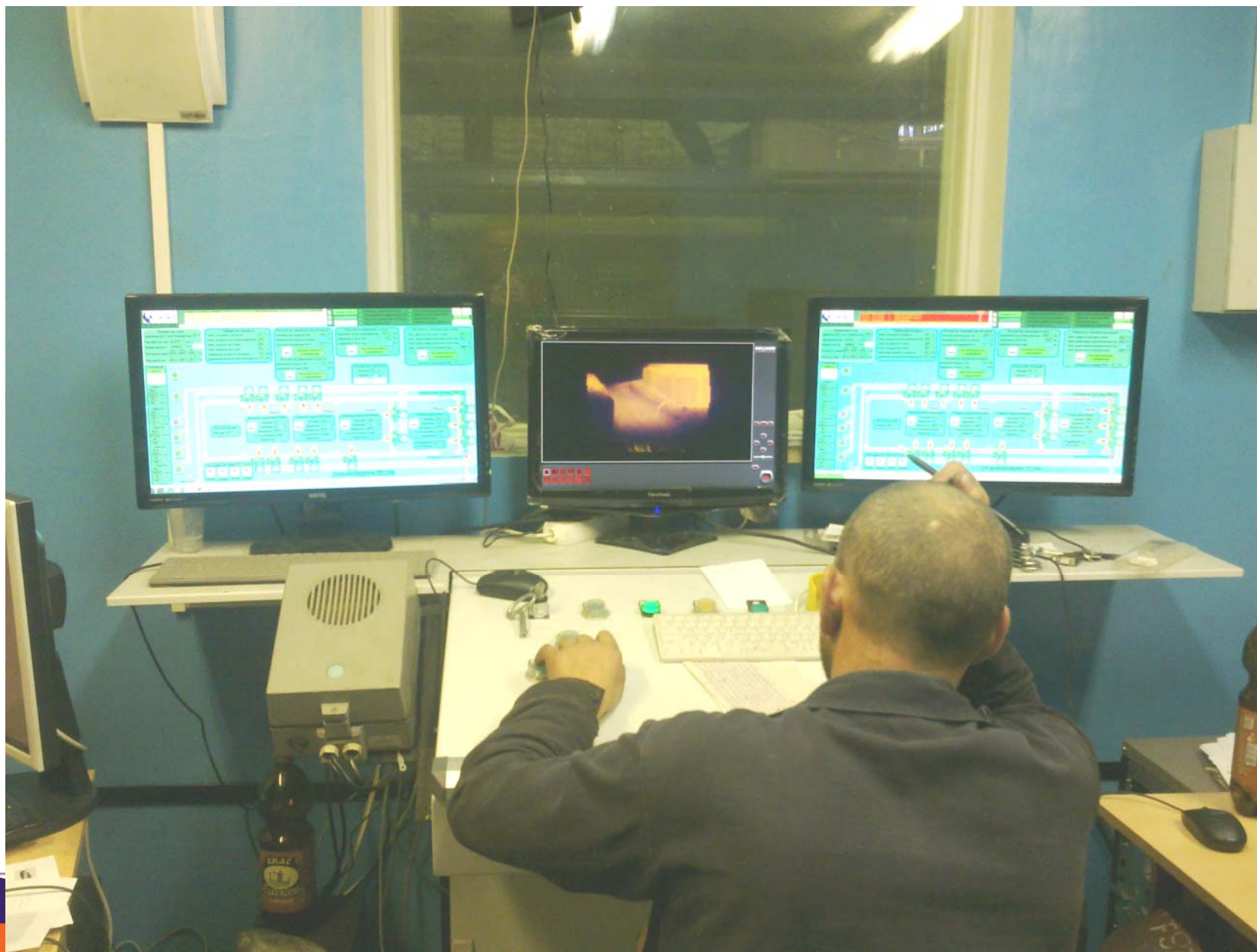
Фото 9. Пульт управления с видеонаблюдением желоба выдачи заготовок.
